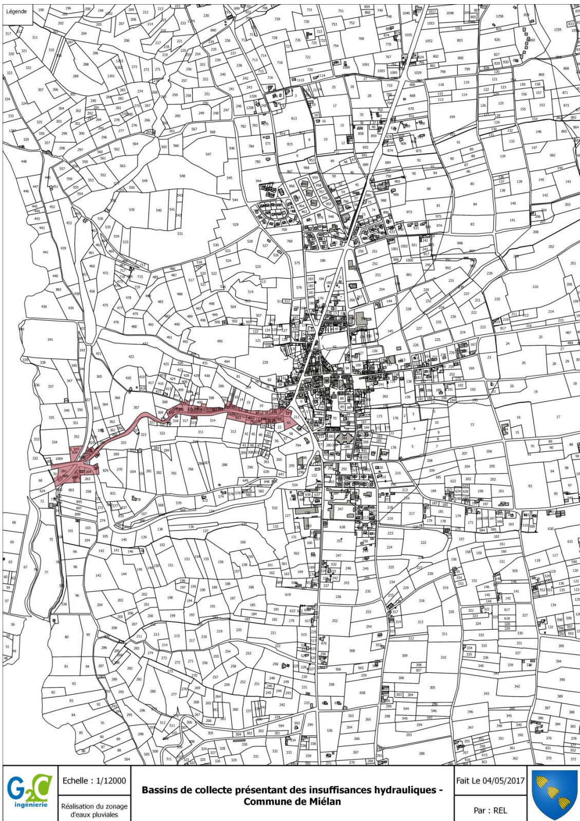
Figure 2: Identification des insuffisances hydrauliques et des sous-bassins associés pour T= 10 ans
