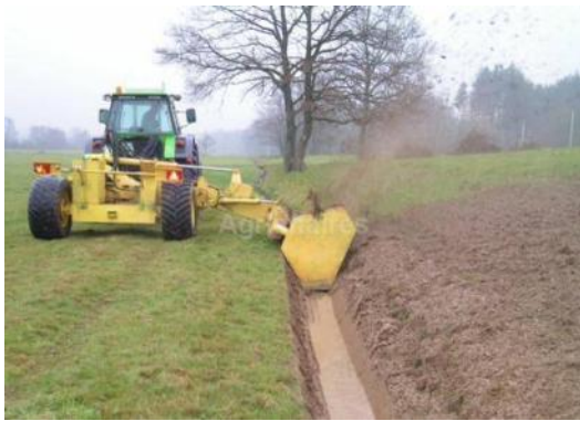
Figure 7 : Exemples de curage et reprofilage de fossés
